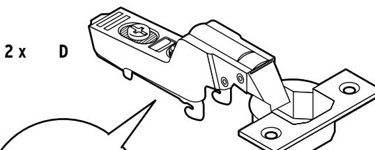
mit Dämpfer | avec amortisseur | con ammortizzatore
