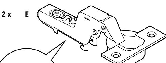
mit Dämpfer | avec amortisseur | con ammortizzatore
